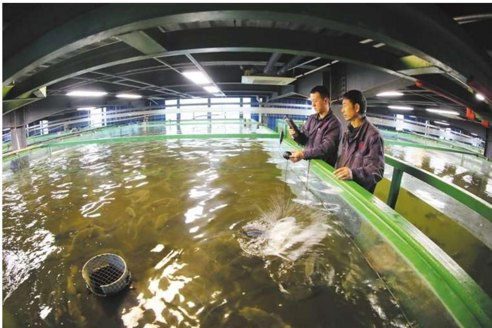
图 3 技术员复测自动传感器检测的水质数据
